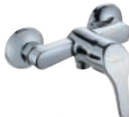
Ref. 24/544 MONOMANDO DUCHA DUNE STANDARD HIDRÁULICA Para ducha mural en latón cromado. Cartucho Ø 40, Mango de ducha, soporte de ducha y flexo inox. de 1,75 m. incluidos. Maneta metálica. 5 años de garantía. 35,10€
