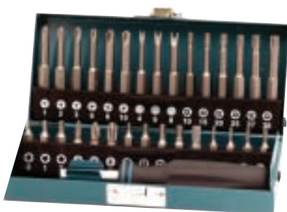
Ref. 24/617 CAJA DE PUNTAS DE SEGURIDAD COMBINADAS 31 PIEZAS WOLFCRAFT GMBH Puntas 25 mm.: hembra cuadrada interior, Phillips, hexágono interior con agujero, Torx con agujero; - Puntas 50 mm: Tri-Wing, Torq, Spanner, Torx con agujero; - atornillador manual
