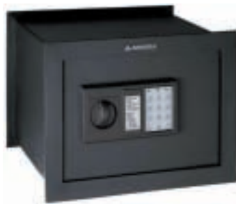
Ref. 24/062 CAJA FUERTE CLASS EMPOTRAR T2 ELECTRÓNICA ARREGUI Apertura electrónica con pomo. Frente de acero de 4 mm. y cuerpo de 2 mm. Bulones de acero de 18 mm. Medidas: 280x380x250 mm.
