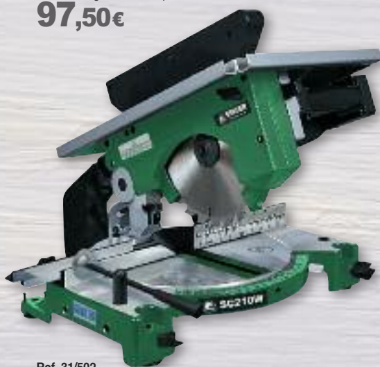
Ref. 31/502 INGLETADORA DISCO 210 STAYER 1200 W. Giros en vacío: 4500 min. Capacidad corte 90: 120x55. Cap. corte 45: 65x55. Tubo PVC: 70 mm. Peso: 12 kg.
