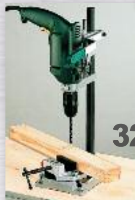
Ref. 31/572 SOPORTE DE TALADRO UNIVERSAL CON COLUMNA REDONDA WOLFCRAFT Placa de fundición gris 160x160 mm. tope de profundidad, muelle de recuperación altura: 500 mm. alcance: 125 mm. altura de trabajo máx.: 345 mm.
