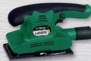
Ref. 31/496 LIJADORA ORBITAL LH 187 C STAYER 150 W. Medidas plato: 187x90 mm. Giros en vacío: 12000. Órbita: 2 mm. Peso: 1,2 kg.
