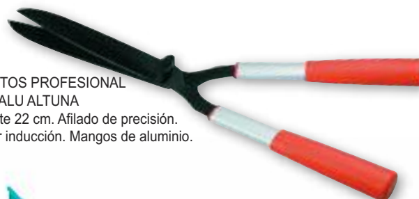
Ref. 32/0128 TIJERA PODA 2 MANOS PROFESIONAL EXTENSIBLE CON MANGOS DE ALUMINIO (60-90 CM) ALTUNA Tijera con mangos tubulares de aluminio, con cuchilla y sufridera de acero, templadas y rectificadas. Topes de plástico. Tornillo central autoblocante. Puños de plástico ergonómicos. Extensible 60-90 cm.
