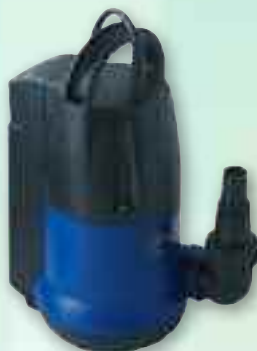
Ref. 39/0738 BOMBA ACHIQUE CON FLOTADOR INTEGRADO 750 W 12500 L/H OUTDOOR Indicada para trabajar en arquetas o lugares estrechos donde una boya podría bloquearse. Permite trabajar en manual incluye 10 m. de cable, codo reductor multidímetro. Altura máx. 8,5 m. Caudal máx. 12500 l/h. Salida de 1 1/2". Diámetro máx de partículas 5 mm. 64,95€
