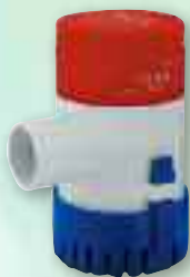
Ref. 39/0735 BOMBA ACHIQUE 12V CC OUTDOOR 12V CC. Ideal para caravanas, embarcaciones, camping, instalaciones fotovoltaicas... Para cualquier sitio donde no haya disponibilidad de corriente 230V CA. 1 m de cable. Altura máx. 4m. Caudal máx. 4.200/h. Salida para tubo 30 mm. 24,95€
