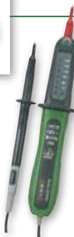
Ref. A055717 COMPROBADOR DE TENSIÓN AC/DC Y POLARIDAD ACHA Detector de tensión con contacto. Indicadores LED de tensión: 12V, 24V, 50V, 120V, 230V y 400V. Indicación de la polaridad de tensiones DC. Comprobación del funcionamiento de diferenciales. IP 54. CATIII 400V.
