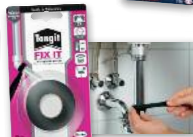
Ref. A055776 CINTA AUTOFUNDENTE FIX IT HENKEL Para pequeñas reparaciones en el ámbito de la fontanería. Se estira hasta 3 veces su longitud, resiste hasta 5 Bar de presión así como rayos UV. Removible sin dejar residuos. 6,63 + 1,39 = 8,02 €
