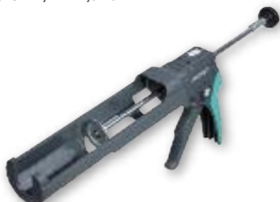
Ref. A056482 PISTOLA SELLADORA MG 350 WOLFCRAFT GMBH Para trabajar con silicona, acrílicos y adhesivo en cartuchos de 310 ml. Fabricada en plástico estable reforzado con fibra de vidrio. Mango de 2 componentes ergonómico. Potente mecánica de avance. Zona de agarre giratoria 360°. Mejora con embolo metálico y mayor presión junto con el cuerpo giratorio completo 360° más aporte de fuerza a 180 kg.
