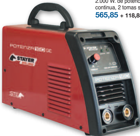
Ref. 33/1337 SOLDADURA 160 A 60% POTENZA 160 STAYER Soldadura MMA estándar mediante electrodo recubierto. Programado para soldar con todos los electrodos. Intensidad (A, X=60%) 160. Electrodo 4 mm. Peso 4,4 kg. Alimentación 230 V. Generador 4,5 KVA. Medidas: 28x13,5x19,5. Cable de alimentación. Cobre puro 3m x1,5 mm². Cable de masa con pinzas. Cobre puro 2m x16 mm². Cable porta-electrodos. Cobre puro 2m x16 mm². Bandolera de transporte. 235,70 + 49,50 = 285,20 €
