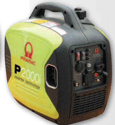
Ref. 35/1196 GRUPO ELECTRÓGENO PRAMAC P2000i, potencia máxima de 2.200 W. Motor Yamaha (MZ80) de 4 tiempos. Gasolina de arranque manual. Toma schuko 230 V. 166A, 1 toma de 12V DC tipo mechero de coche, conexión de paralelo (cables incluidos). Depósito 4,2 l. Autonomía 5,3 h. Para aplicaciones ligeras. Peso 22 kg. Se puede conectar en paralelo (3.2 kW.) 753,10 + 158,15 = 911,25 €
