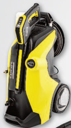
Ref. 35/1766 HIDROLIMPIADORA K 7 PREMIUM FC PLUS KÄRCHER Caudal 600 l/h.; presión 180 bar.; 3000 W.; manguera alta presión 10 m.; motor refrigerado por agua; lanza turbo; lanza vario power. 462,77 + 97,18 = 559,95 €
