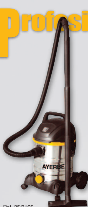
Ref. 35/0165 ASPIRADOR INOX. 20 L 1300 AYERBE Aspirador para polvo y agua. Depósito inox. 1.300 W. Depresión: 1.600 mm./ H 2 O. Caudal 170 m 3 /h. Depósito 20 l. Peso 4,5 kg. Accesorios. 83,80 + 17,60 = 101,40 €
