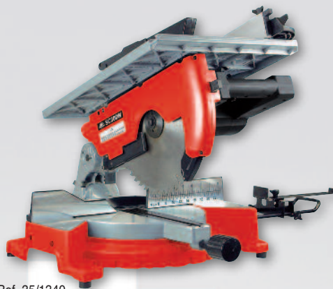
Ref. 35/1340 SC 300 W STAYER 2000 W. Giros en vacío min-1 4200. Disco Ø 305x2.5x30 mm. Peso 20 Kg. Capacidad a 90° 185x85 mm. a 45° 125x85 mm. Tubo PVC Ø 120 mm. Monofásica. Base y Mesa superior en aluminio. Predispuesta para mordazas horizontales y para la aspiración. Guía con tope de regulación. 345,30 + 72,51 = 417,81 €
