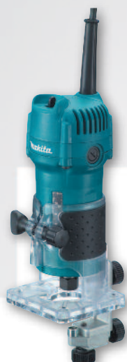
Ref. 35/0773 FRESADORA 3709 MAKITA 530 W. y 30.000 rpm. Ideal para el fresado de cantos en madera. Pinza de 6 mm. y 1,5 Kg. de peso. Base plana regulable en altura y sujeción antideslizante con elastómero para un mejor agarre de la herramienta. 64 + 13,44 = 77,44 €
