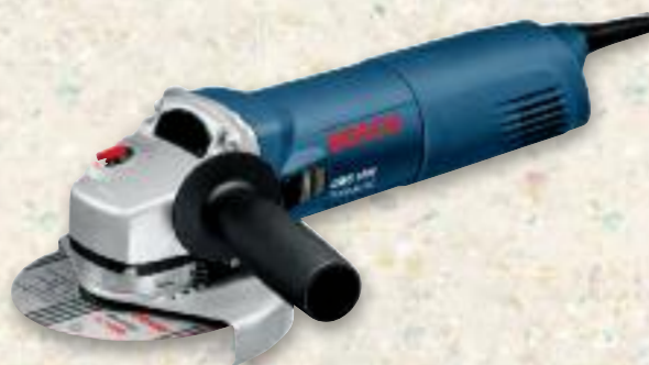
Ref. A027106 MINIAMOLADORA GWS 1400 ROBERT BOSCH Potencia absorbida 1.400 W. Velocidad de giro en vacío 11.000 r.p.m. Potencia útil 820 W. Rosca del husillo portamuela M 14. Ø disco 125 mm. Plato lijador de goma, Ø 125 mm. Cepillo de vaso, Ø 70 mm. Longitud 298 mm. Altura 102 mm. Peso 2,2 kg.
